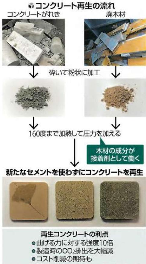
建物の解体現場で生じるがれきをコンクリートに再生する研究に、東京大などの研究チームが取り組んでいる。材料は、コンクリートがれきと廃木材。この二つの「ごみ」が、コンクリートに生まれ変わる。製造過程で大量にCO<sub>2</sub>を排出するセメントを使わないため、地球温暖化対策にも貢献すると期待される。(三浦真)
