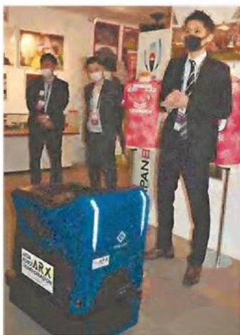
① スタジアムギャラリーをオゾンで除菌するロボット ② 観客席外の通路を巡回する警備ロボット
