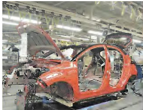
自動車を組み立てているトヨタ自動車の工場
